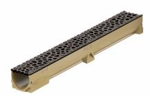
EUROLINE 100 VORONOÏ, caniveau en béton polyester avec profil en V et passage libre optimal grâce à la grille design, clipsée sans vis, en fonte, classe B 125
