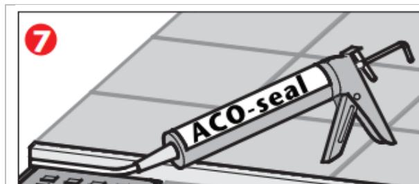
Si les carreaux sont également installés sur le canal de douche sous la pente, les joints de raccordement (canal de douche et Showerstep) doivent être scellés avec ACO Seal (ou un produit d'étanchéité / scellant équivalent).
