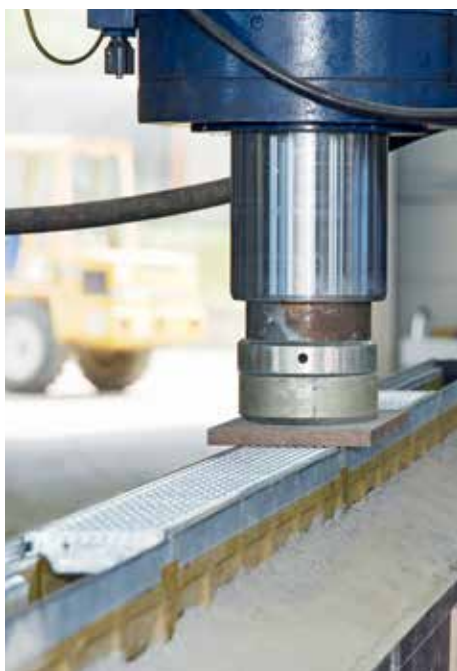
Waterdichtheidstesten na lange duur simulatie
