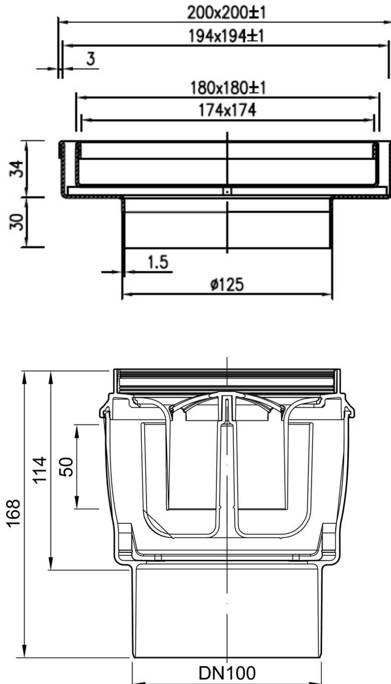
La rehausse présente une hauteur de 64 mm, dont 11 mm sont intégrés dans le corps du siphon de sol.
