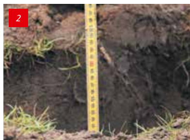
Graaf een sleuf van 125 cm diep en 20 à 30 cm breed. Maak dat de sleufbodem egaal is.
