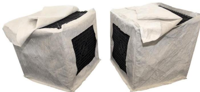
3. La caisse enveloppée est maintenant posée sur le lit de gravier. Si plusieurs caisses sont utilisées, elles doivent être posées directement l'une à côté de l'autre. Le « couvercle » du géotextile de chaque caisse doit être placé sur la caisse adjacente.
