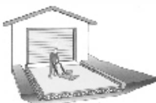
Tout pavage requiert une bonne assise, les dalles gazon n'y font pas exception. Comme indiqué, la couche de fondation en gravier doit être recouverte d'un géotextile drainant et d'une couche de sable. Optez pour un mélange de sable aux propriétés portantes et drainantes suffisantes ! Vous devez pouvoir damer le sable avec une plaque vibrante ; il doit avoir une capacité portante tout en étant suffisamment perméable.
