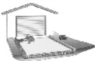
Posez les dalles sur la fondation égalisée. Celles-ci sont raccordées longitudinalement, sur le petit côté, pour poser ensuite la seconde rangée transversalement, sur le long côté. Respectez de préférence un schéma de pose en quinconce. Vous posez ainsi les dalles rangée après rangée dans le sens de roulage du trafic. Le schéma de pose nécessite que les extrémités d'une rangée sur deux soient sciées en leur milieu.
