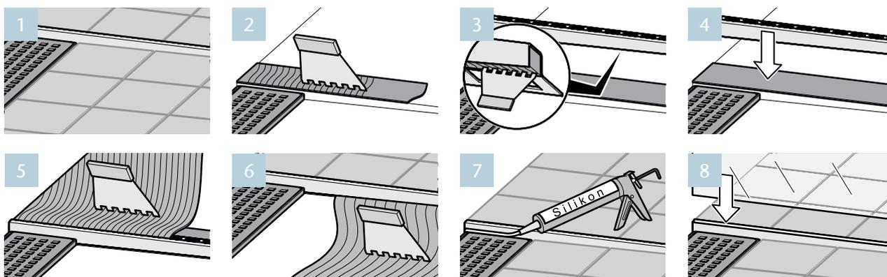
**1** Le caniveau de douche est placé dans la chape. Celle-ci doit être placée à une hauteur correcte afin que la pente de 1,5 à 2 % puisse être appliquée. À la transition entre la douche à l'italienne et le sol de la salle de bain, un bord en forme de coin est créé sur lequel est placé le ShowerStep.
